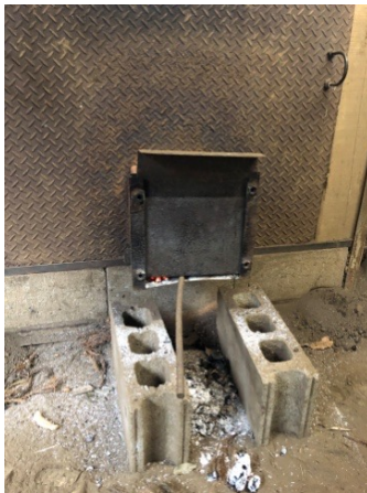
自発炭化中 通風孔 13Φmm丸棒スキ分開く
