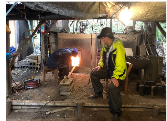
焚き口から熱風を窯 内に入れて自発炭化 待ち
