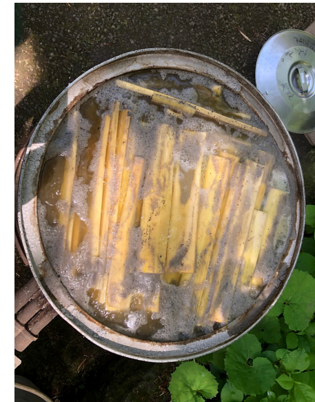
灰を入れてボイルしたり(メ ンマになって失敗?)、水 に漬けたり 竹繊維を分離 する方法をトライ中です
