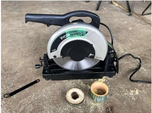
劣化故障した旧モデルと基本スペックは同じ。高速切斷機にチップソーを付けての竹切断。作業者限定で使用
