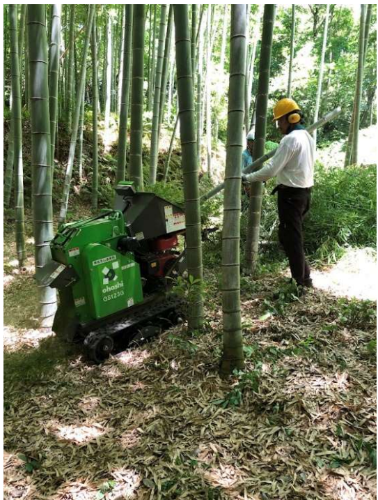
チップパー機で 枝や 細い竹は、チップ化し 竹林内へ 肥料として散布
