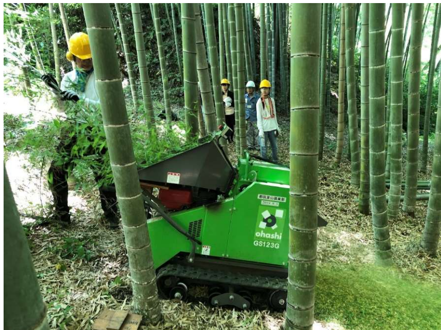
チップパー機で 枝や 細い竹は、チップ化し 竹林内へ 肥料として散布
