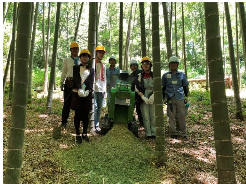
チップパー機で 枝や 細い竹は、チップ化し 竹林内へ 肥料として散布
