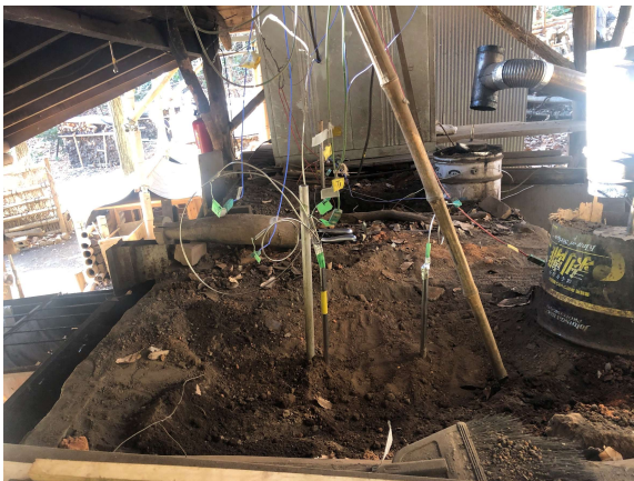
窯中間部の温度を200mm奥で追加測定。このSUS管は、ドラム缶内へ貫通していない
