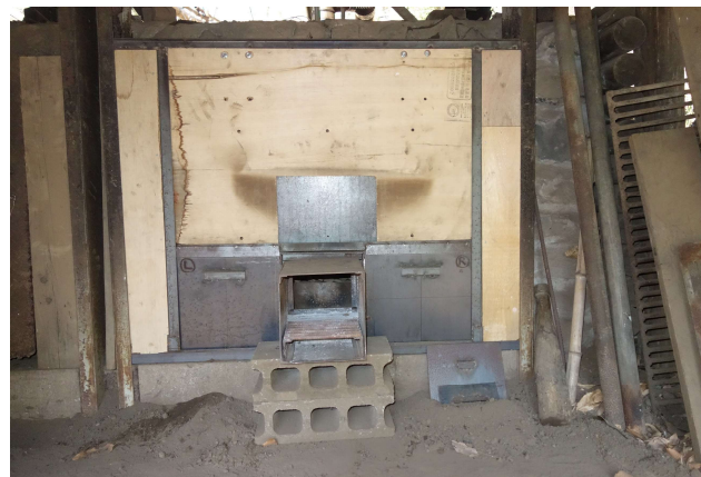
焚口上部の合板はカットし、炎がかかっても燃えない裏面の鉄板を露出させた
