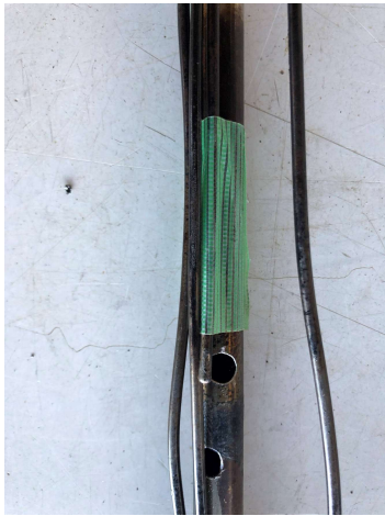
熱電対先端より20mm下に充填剤(耐熱セメント)を注入する孔を追加加工
