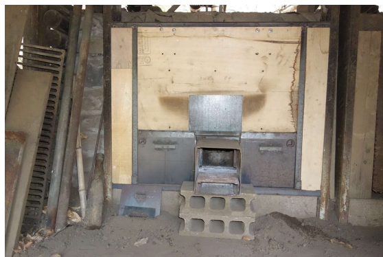
脱着式焚口、土留め前板の分割構造で 軽量化を実現
