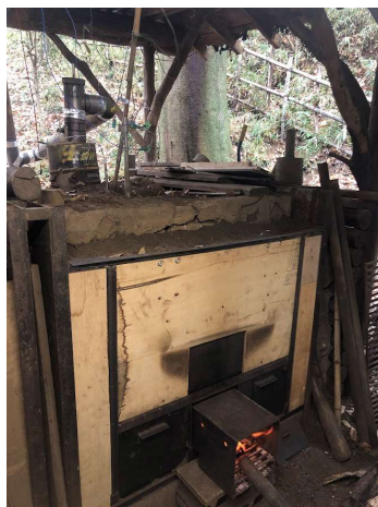
焚口で薪に着火し、熱風をファンで窯内へ送り込む
