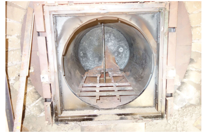
窯内のロストル、熱電対ガイド管、煙道絞り込みレンガの全体写真
