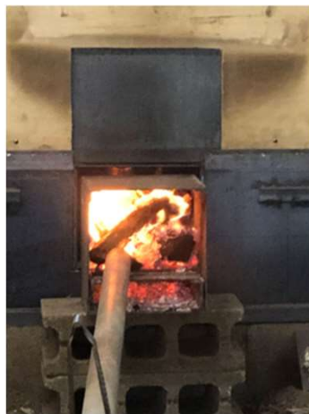
焚口で薪に着火し、熱風をファンで窯内へ送り込む
