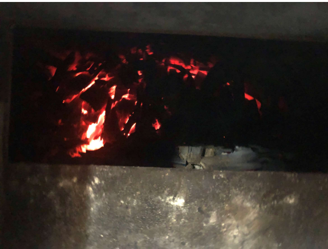
精錬 前蓋全開 直後。空気が入り、窯内ガスが燃焼し、次第に窯内が明るくなり、温度急上昇
