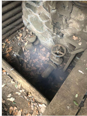
焚口から着火直後、窯裏側のすき間から煙が漏れているのを確認。温まると消えた
