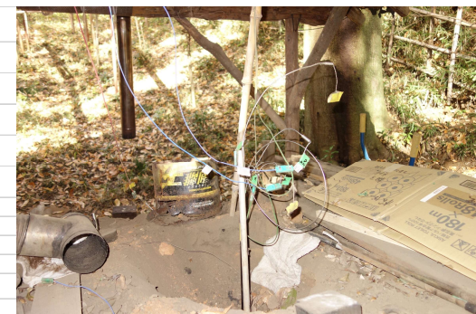
SUSガイド管と熱電対 上部よりの挿入状態
