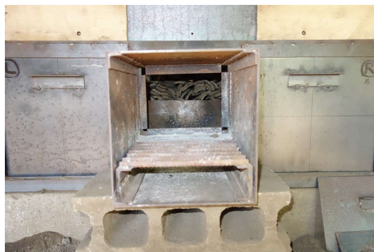
取り付けた焚口から窯内を見る。窯内への熱風取り込み口のサイズと位置が重要な設計ポイント
