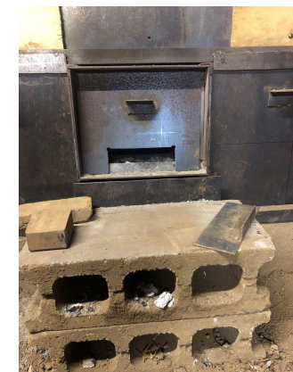
精錬開始直後30分間の空気取り入れ口サイズ。その後全開へ
