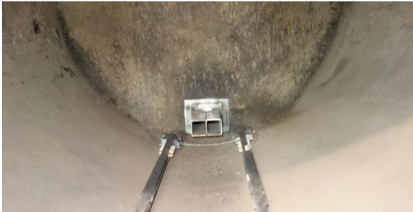
接続部品（通称弁当箱）をオリジナルの外窯SUS缶に接続した状態
