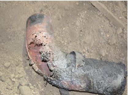
旧窯煙突エルボの 損傷状態
